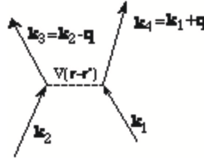
Figura 5.17: Diagrama para a interacção de Coulomb entre dois electrões de vectores de onda \mathbf{k}_1 e \mathbf{k}_2 . As setas indicam a direcção do tempo. A linha tracejada representa a interacção com troca de momento \hbar\mathbf{q} . Note-se que \mathbf{q} é um vector da rede recíproca, \langle k'|V|k\rangle \neq 0 se \mathbf{q} = \mathbf{k}' - \mathbf{k} = \mathbf{G} .
