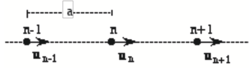
Figura 5.2: Rede unidimensional com um átomo por célula e parâmetro de rede a . Os vectores \mathbf{u} representam os desvios às posições de equilíbrio.
